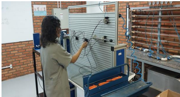
Figura 1 - Manutenção nos componentes pneumáticos
