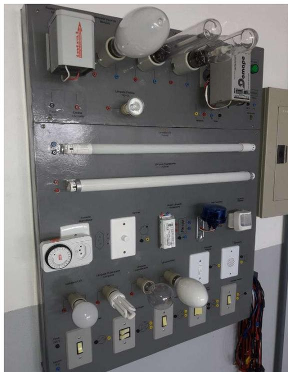
Figura 1 – Painel Didático instalado no laboratório de eletricidade do IFSC campus Lages
